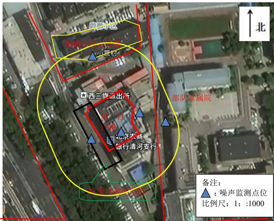
图3-1 项目噪声监测点位及执行标准图
