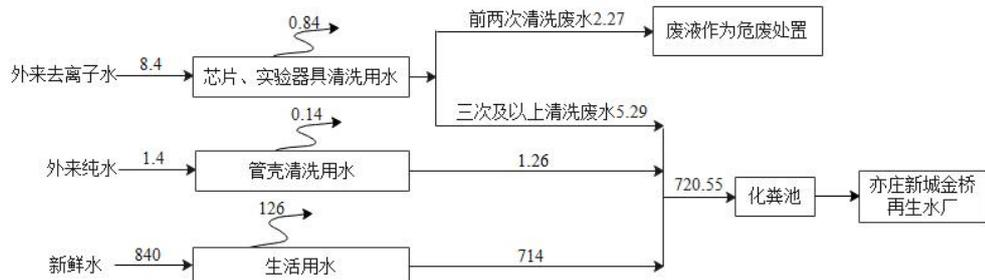
图 2-1 本项目水平衡图 (m<sup>3</sup>/a)
